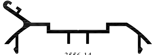
3556-14 Kapı Adaptörü 0.463 Kg/m
