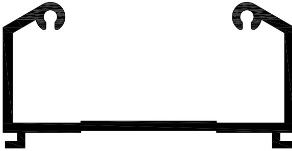
3587-30 U Bağlantı Profili 1.193 Kg/m
